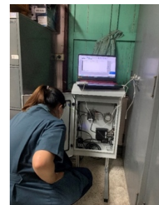
ภาพที่ 3.9 การเชื่อมต่อ computer เข้ากับ Data logger เพื่อเก็บข้อมูล
