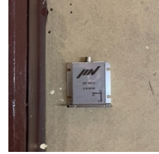
ภาพที่ 3.7 Accelerometer sensors รุ่น VP-8013 ของบริษัท IMV
