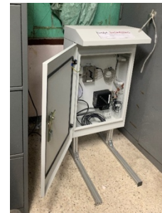
ภาพที่ 3.8 ภายนอกและภายในของ Data logger รุ่น EDS-400A ของบริษัท KYOWA
